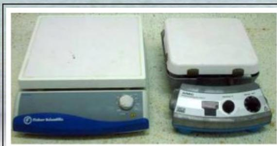
Figura 6. Mantas de calentamiento con y sin agitación
