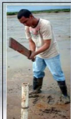
Figura 9. Toma de muestra, se golpea el tubo para enterarlo a 20 cm de profundidad
