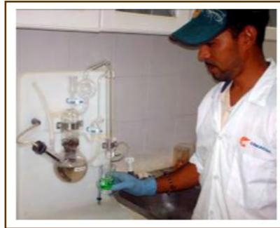
Figura 20. Proceso de destilación.
