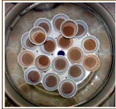
Figura 33. Proceso de enfriamiento de las cenizas dentro del desecador.
