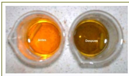
Figura 14. Cambio de color por titulación con solución FAS.
