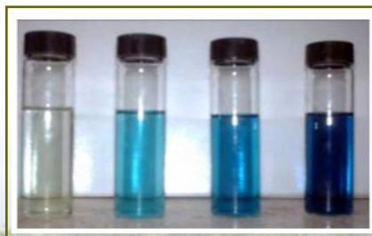
Figura 16. Cambio de color por reacción con el amonio. La intensidad del color es proporcional a la concentración de amonio en la muestra.
