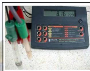
Figura 27. Equipo Multiparámetro, (medidor de pH, Conductividad eléctrica, Potencial de oxido reducción y salinidad)
