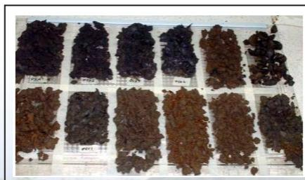
Figura 11. Secado de muestra a temperatura ambiente.
