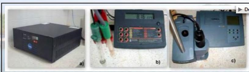
Figura 5. a) UPS, b) Equipo multiparametro y c) Oxímetro de mesa.
