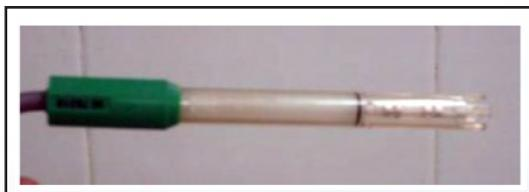
Figura 26. Electrodo de Conductividad eléctrica, salinidad y sólidos totales disueltos.
