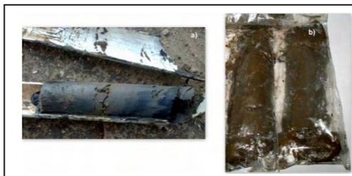
Figura 10. a) Apertura del tubo de muestreo, b) empaque de muestra
