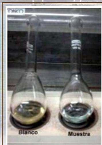
Figura 37. Cambio de color de la muestra por digestión.
