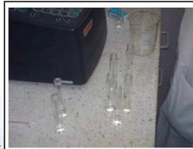
Figura 17. Cuantificación de nitrato (NO<sub>3</sub>) en muestras de agua, cabe notar que en esta técnica no se presenta cambio de color.
