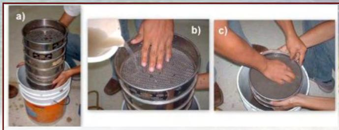
Figura 44. Proceso de filtración (a) y lavado (b y c) por tamices de diferente tamaño
